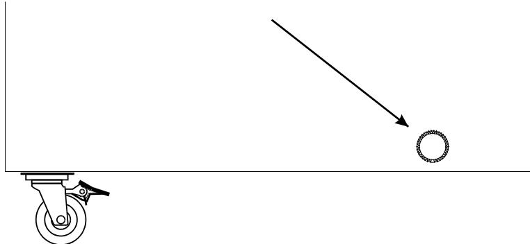
Coloque un recipiente debajo de la válvula para recoger el agua derretida.
