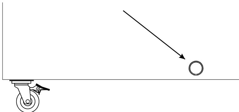
Der placeres en beholder under ventilen for at opsamle tøvand.
